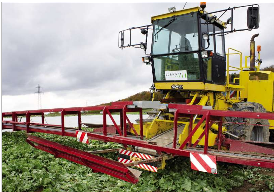
An den Rollbändern der umgebauten Ropa-Zuckerrübenverlademaus der Max Schwarz AG arbeiten bis zu zwanzig Erntearbeiter.
