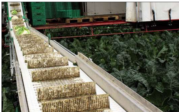
Die neueste Generation der Erntebänder läuft mit Ketten. La nouvelle génération de tapis de récolte est équipée de chaînes.
