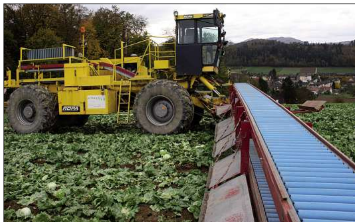
Die Max Schwarz AG arbeitet mit einer umgebauten Zuckerrübenverlademaus. L'exploitation Max Schwarz AG utilise une chargeuse automotrice de betteraves sucrières transformée.
