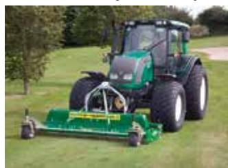
Major est fabricant de tondeuses et faucheuses broyeuses pour places de sport et de golf, terrains d'aviation, hippodromes et parcs. Des modèles de 1.35 - 6.10 m de largeur de travail sont offerts pour le montage sur le relevage avant ou arrière et en versions trainées. Le système breveté Grounds-major permet d'éviter les rayures lors de la tonte.
