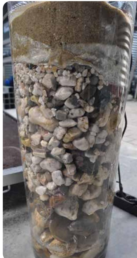
Structure d'un filtre à sable.
